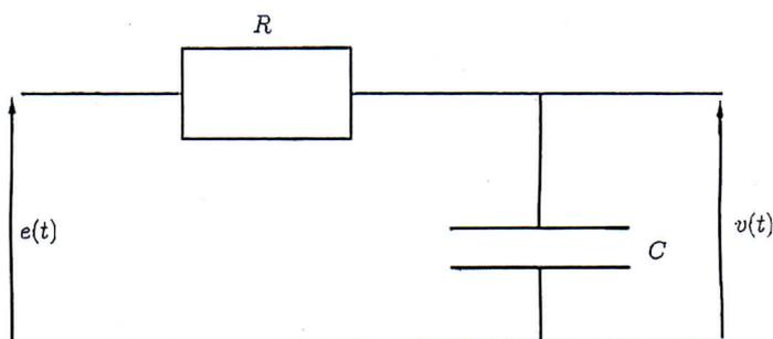
Le circuit est alimenté par une tension « source » représentée par une fonction  $e$ . La tension aux bornes du condensateur est représentée par une fonction  $v$ . Si on considère cette tension comme signal de « sortie », le circuit joue le rôle de filtre passe-bas.
